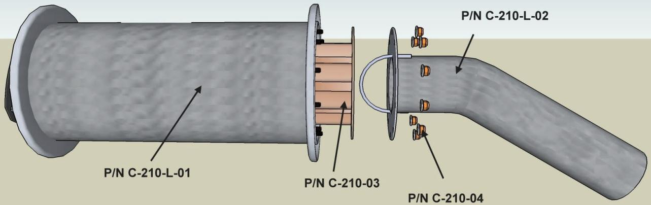
Schalldämpfer Rechts komplett / Silencer Assy Right = P/N C-210-R
